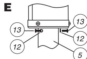
**Внимание: ОКОНЧАТЕЛЬНУЮ ЗАТЯЖКУ БОЛТОВ ПРОВОДИТЕ ПОСЛЕ ПРОВЕДЕНИЯ ПРОВЕРКИ НА УТЕЧКУ ГАЗА!**
